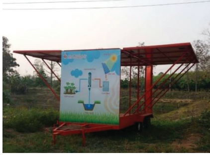
ภาพที่ 1 ระบบสูบน้ำพลังงานแสงอาทิตย์บนรถพ่วง 4 ล้อเคลื่อนที่
